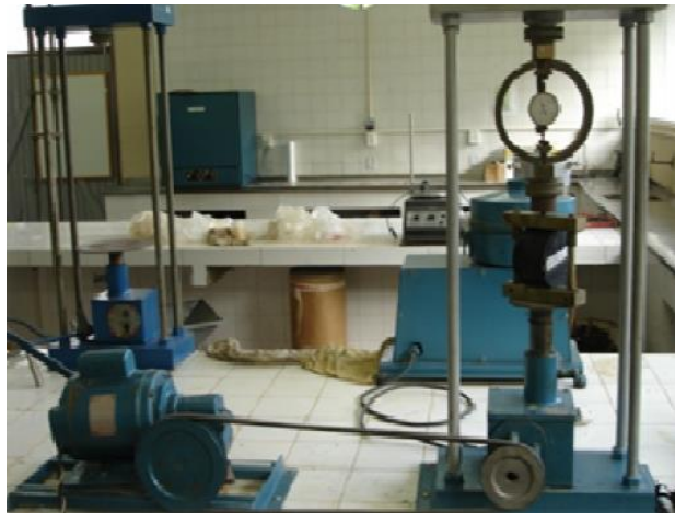
Figura 8 – Prensa mecânica utilizada para o ensaio de Resistência à Tração por Compressão Diametral.
