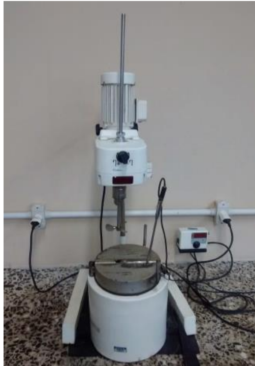
Figura 6 - Misturador de cimentos asfálticos modelo 722D – LEP/UFCG.
