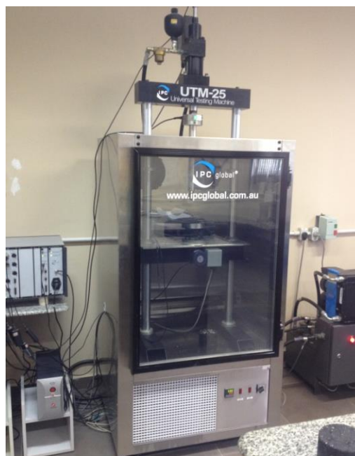
Figura 10 – Equipamento utilizado no ensaio de Módulo de Resiliência – Prensa UTM-25.
