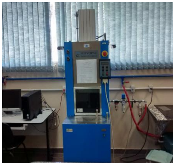
Figura 7 – Compactador Giratório (Superpave Giratory Compactor – SGC) – LEP/UFCG.
