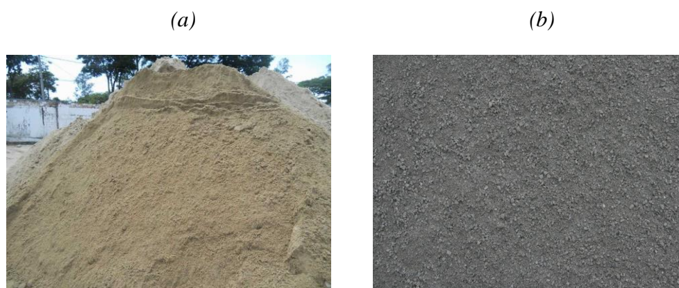
Figura 2 – Ilustração dos agregados miúdos: (a) areia média e (b) pó de pedra.
