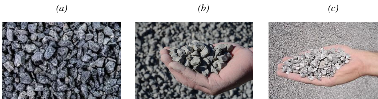
Figura 1 – Ilustração dos agregados graúdos: (a) brita 25,0mm, (b) brita 19,0mm e (c) brita 12,5mm.
