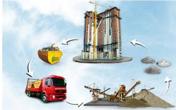
Figura 10 – Funcionamento de uma Usina de Reciclagem de resíduos de Construção Civil
