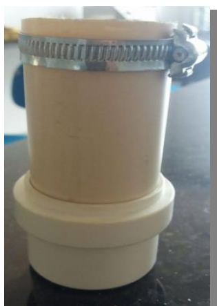
Figura 6 – Molde cilíndrico de PVC
