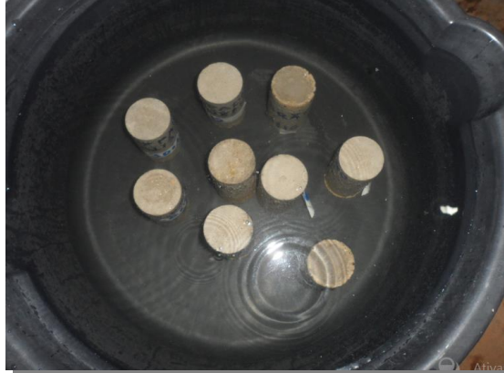
Figura 8 – Cura úmida dos corpos de prova
