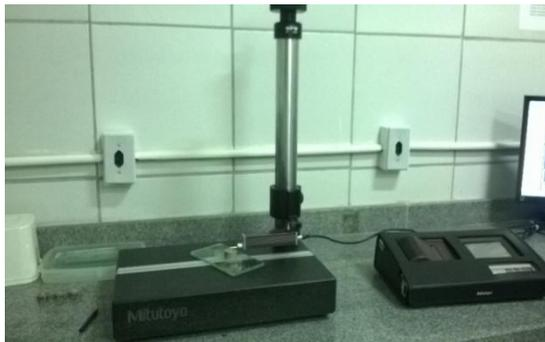
**Fotografia 4.5.1** Rugosímetro Mitutoyo SJ-301(Surf Test)
