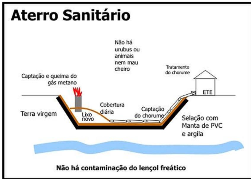
**Figura 12: Estrutura de um aterro Sanitário**
