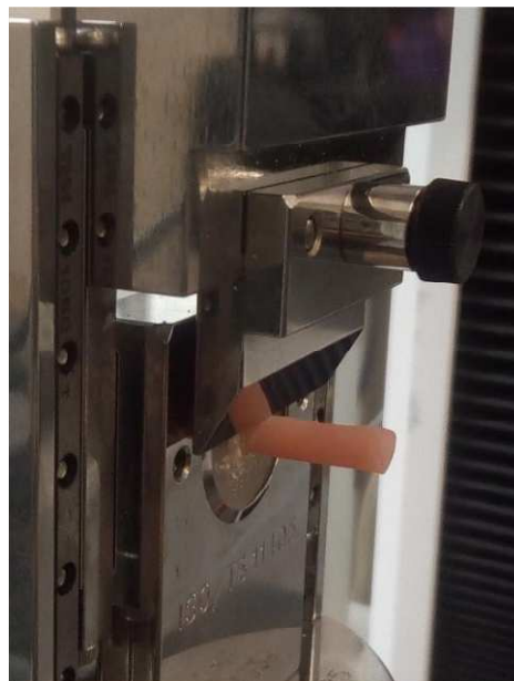
Figura 4: Corpo de prova posicionado na máquina universal de ensaio
