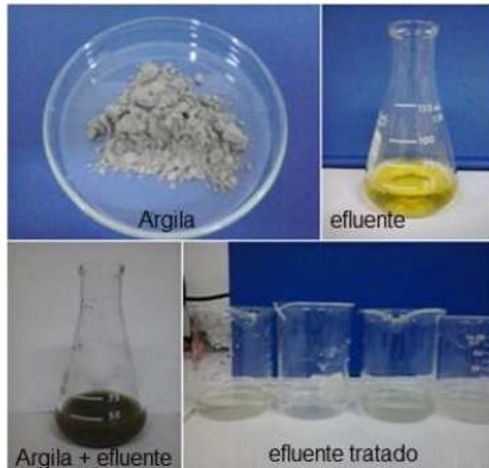
Figura 6- Representação das etapas do ensaio de remoção do corante Amarelo Reativo BF-4G.
