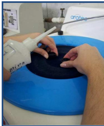
Figura 4.6.5 – Polimento com pasta de alumina em Arotec
