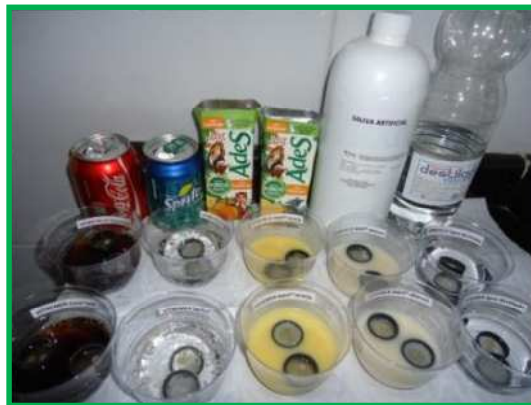
Figura 4.7.1 – Imersão nas bebidas utilizadas durante o desafio erosivo
