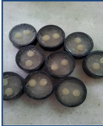
Figura 4.6.3 – Corpos de prova embutidos em resina acrílica
