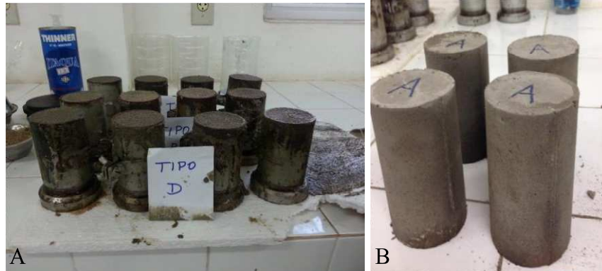
Figura 4: (A) Corpos de prova moldados e (B) desmoldados.
