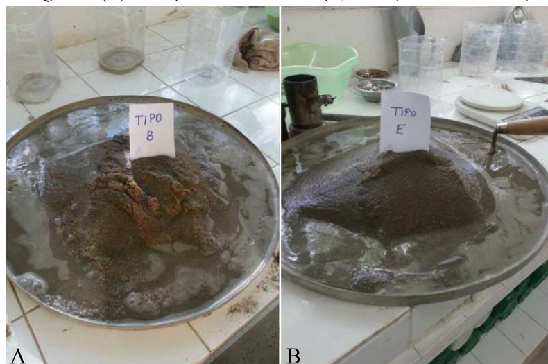
Figura 2: (A) Variação do Fator a/c 3 e (B) Variação do Fator a/c 2,5.
