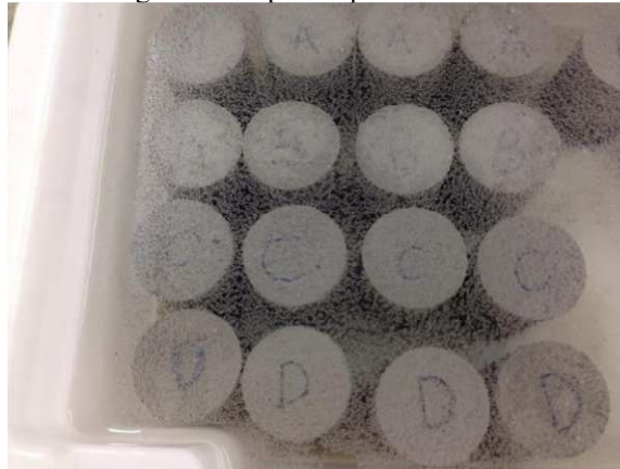
Figura 5: Corpos de prova em cura.
