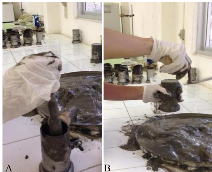
Figura 3: (A) Confeção dos corpos de prova com golpes uniformes e (B) rasadura.
