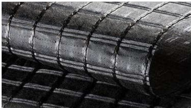
Figura 10- Geogrelha utilizada (Huesker).
