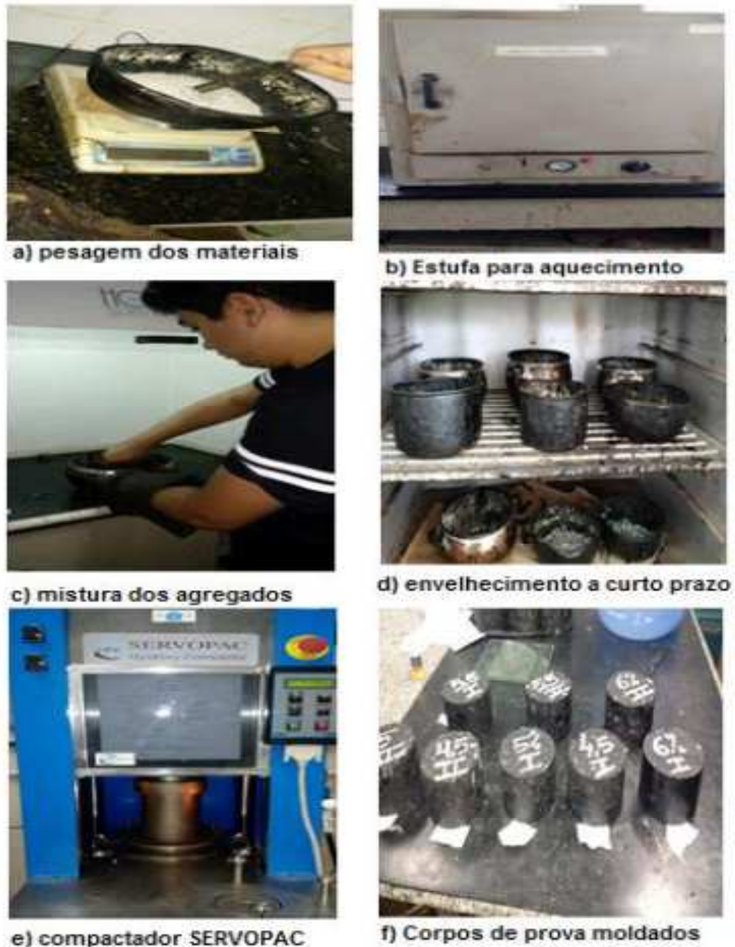
Figura 17- Procedimento de moldagem dos corpos de prova.
