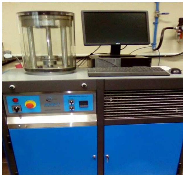
Figura 24- Equipamento AMPT para realização do ensaio.
