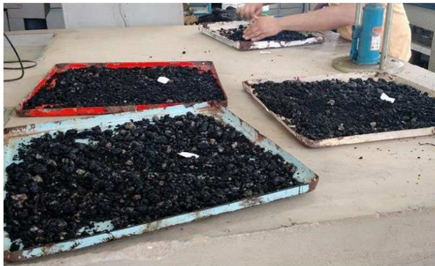
Figura 19- Amostras para realização do ensaio Rice Test.
