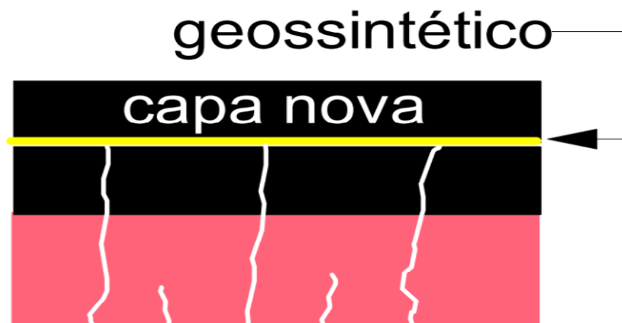
Figura 2- Geossintético na reflexão de trincas (Adaptado, IGS Brasil).
