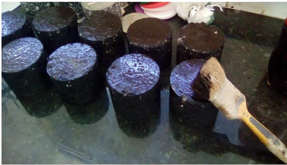
Figura 21- CP's após a aplicação da emulsão asfáltica.
