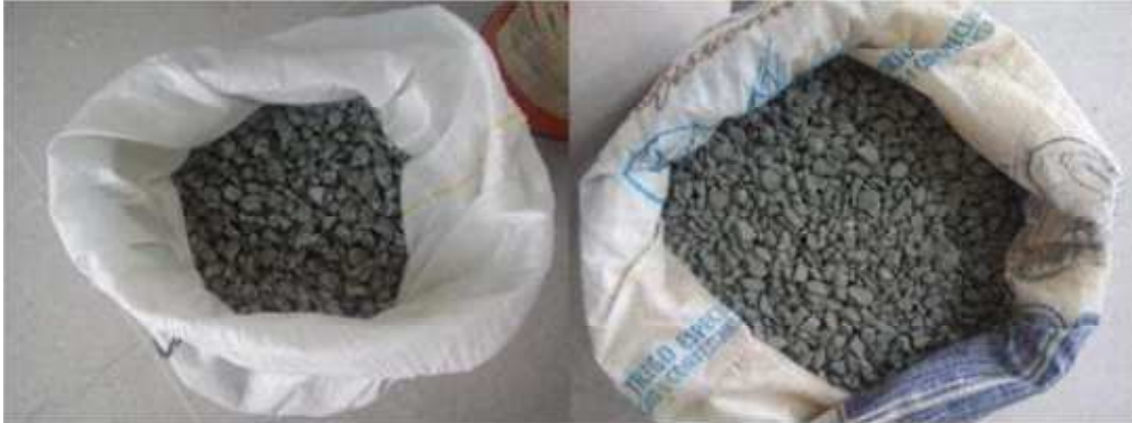
Figura 7- Agregados graúdos brita 19 e brita 12.5, respectivamente.
