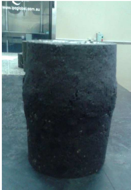
Figura 25- CP com sinais de estufamento.
