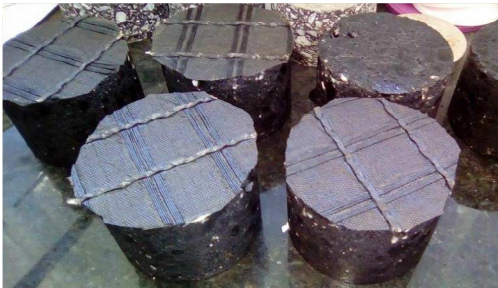
Figura 22- CP's com a geogrelha.
