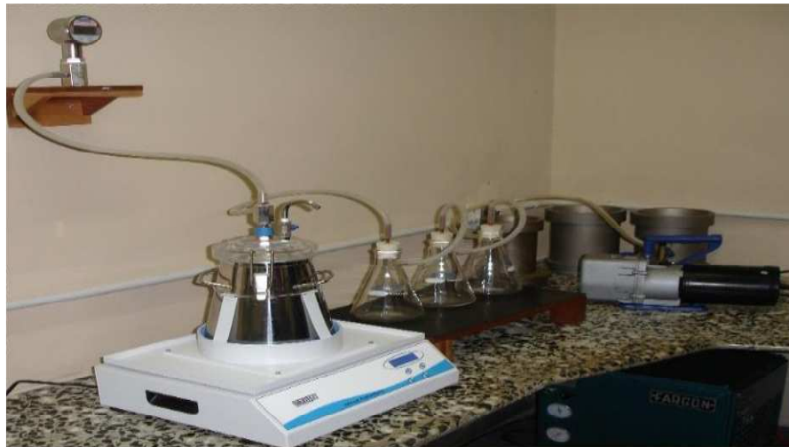
Figura 18- Aparelhagem para o ensaio Rice Test.
