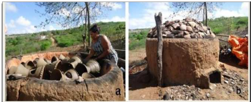
Figura 15. (a) Loiceira organizando as peças no forno (b) Forno cheio com as peças de barro e coberto com cacos de panelas quebradas, pronto para a cocção das “loijas”.
