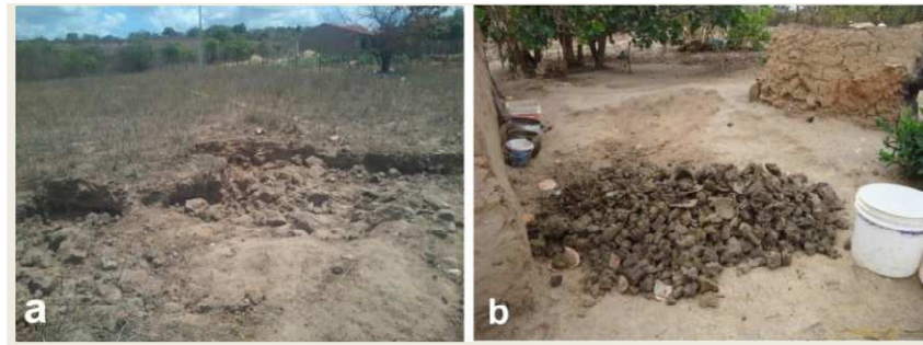
Figura 10. (a) Barro no local de extração; (b) Barro no quintal para preparação da massa para moldar as peças.
