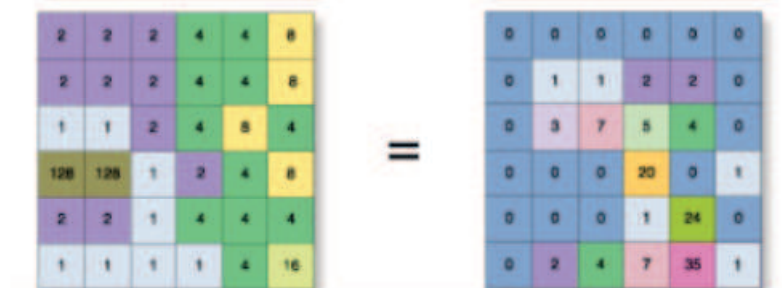
Figura 6 – Conversão da grade numérica de direção de fluxo na de fluxo acumulado
