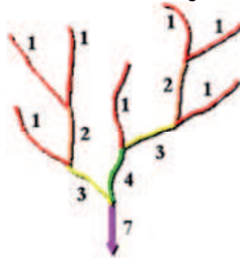
Figura 7 – Esquema de ordens de rede de drenagem – Método de Strahler
