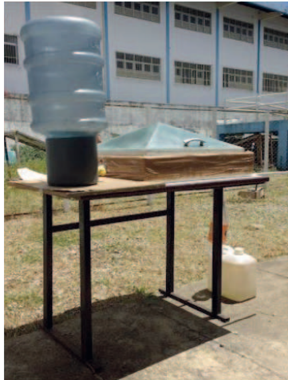
Figura 5 - Montagem completa do dessalinizador tipo pirâmide
