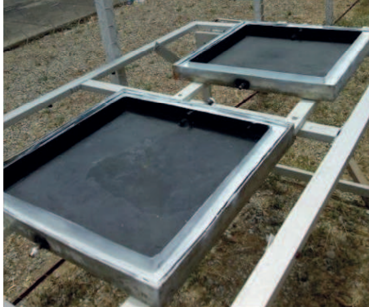
Figura 3 - Montagem da parte interna do dessalinizador do tipo pirâmide
