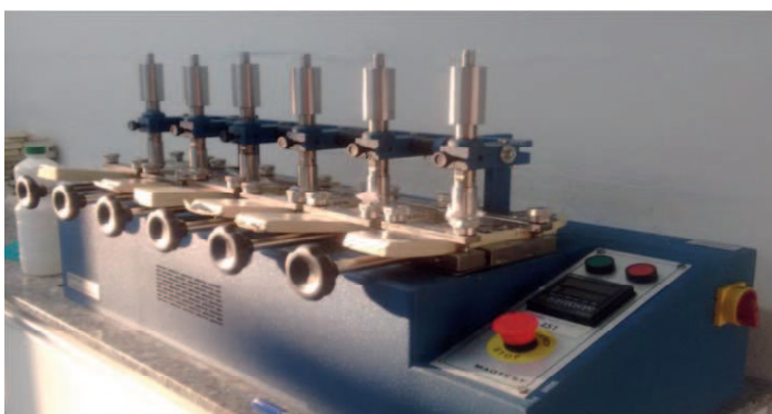
Figura 6: Análise de Resistência à Abrasão em máquina Veslic.
