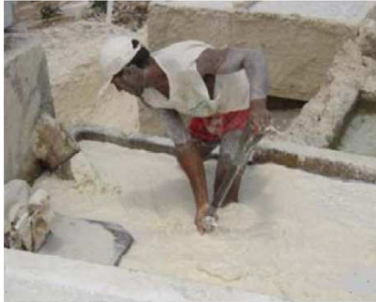
Figura 6. Beneficiamento do caulim de forma rudimentar. Fonte: Silva et al. (2008)
