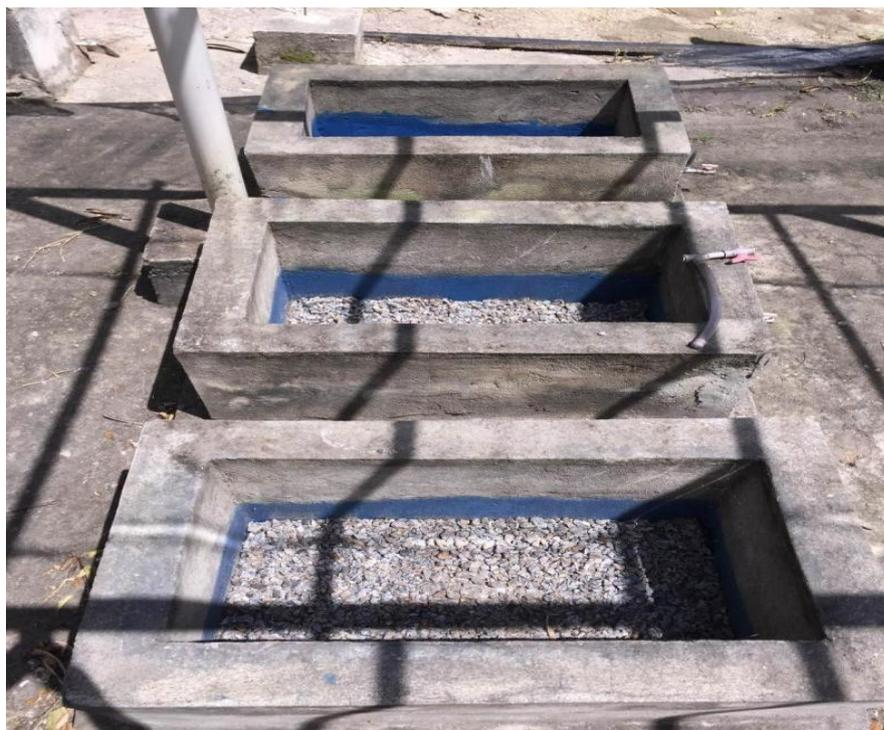
**Figura 2.** Lisímetros tratados com um impermeabilizante Tecryl D3 (para evitar eventuais infiltrações e vazamentos dos lisímetros) e preenchidos com uma camada de 5 cm de brita.
