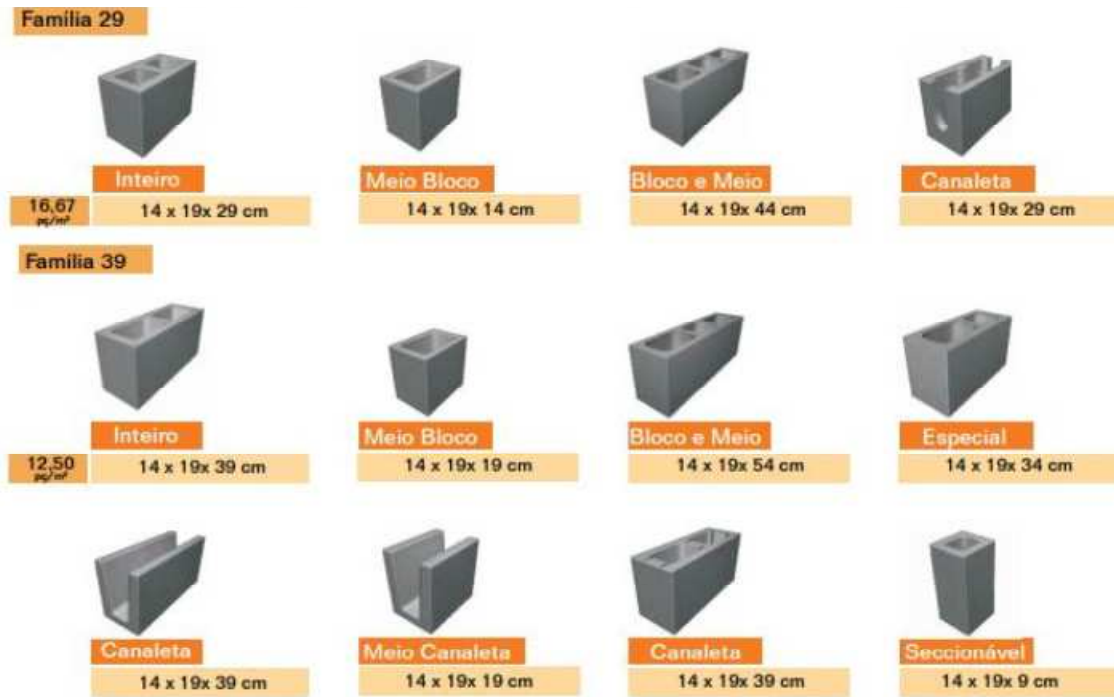
Figura 4: Blocos estruturais de concreto da família 29 e 39.
