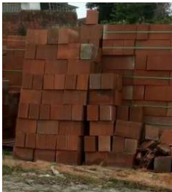
Figura 43: Blocos quebrados pelo mau armazenamento
