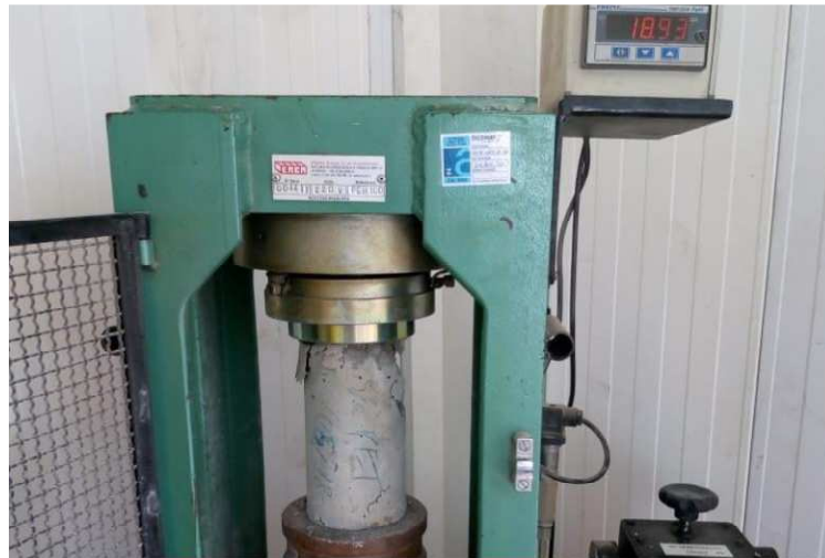
Figura 09: Ensaio de Compressão Axial
