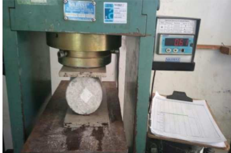
Figura 08: Ensaio de Compressão Diametral
