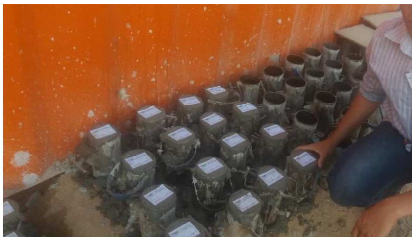
Figura 07: Corpos de prova com adição de fibras
