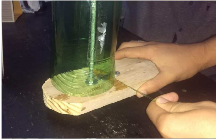
Figura 01: Protótipo de extração de fios
