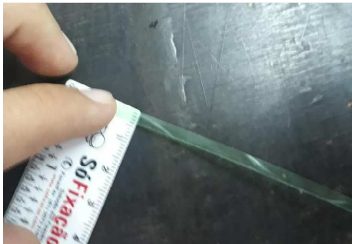
Figura 03: Medição de Poliéster 4 mm
