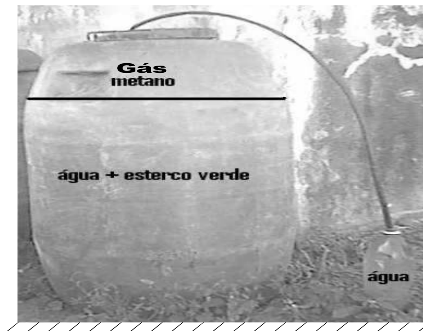
Figura 01. Ilustração do processo de produção do biofertilizante comum.
