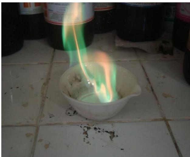
O  $\text{H}_2\text{SO}_4$  concentrado removeu a água formada. O borato de etila é volátil e conferiu uma coloração à chama após a ignição com o etanol na cápsula de porcelana. A chama adquiriu uma coloração verde característica, observado na figura ao lado, devido à transição de níveis de energia. Assim, quando o elétron transita entre os níveis, emite uma cor verde, típica dos orbitais “d”.
