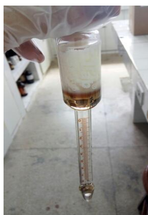
Figura 4: Mistura composta por três fases, leite, ácido sulfúrico e álcool isoamílico
