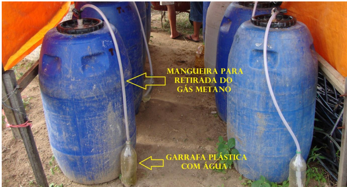
Figura 1. Esquema de obtenção de biofertilizante via fermentação anaeróbia.
