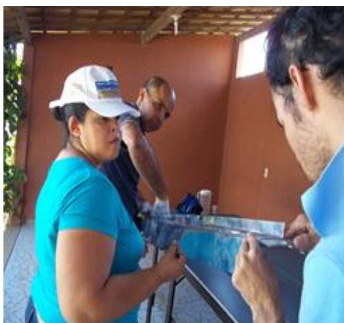
Figura 10. A equipe dobrando as calhas Fonte: Arquivo pessoal
