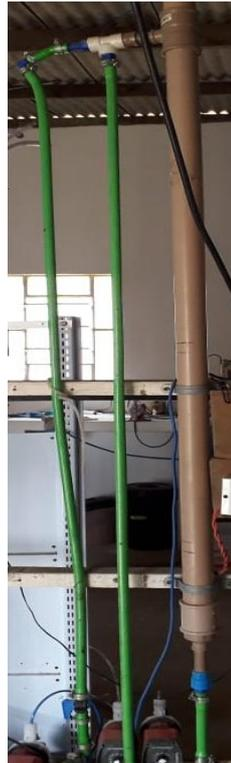
Figura 13. Reator BRAnMD com módulo de membrana externo.
