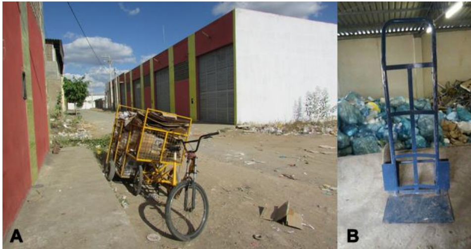
Figura 2. A) Bicicleta para transportar os resíduos (ciclolix). B) Carro de cargas (capacidade de até 300 kg).
