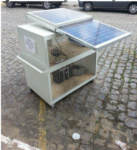
Figura 7. Sistema de geração de energia fotovoltaica.
