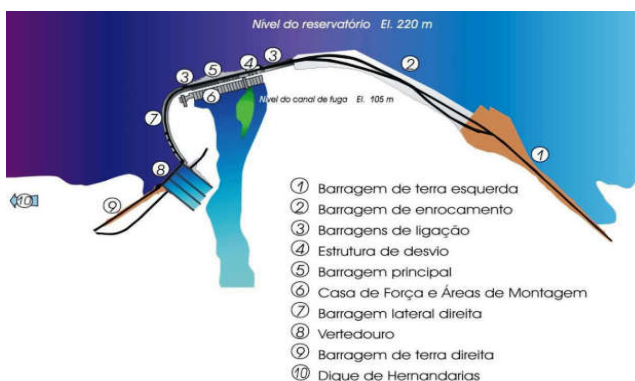
Figura 12 - Barragem mista (Itaipú)
