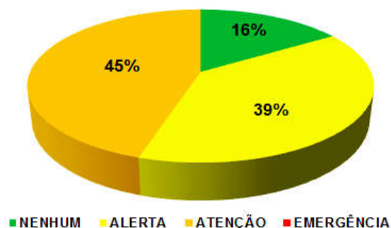
Figura 39 - Percentual das anomalias da barragem Algodões de acordo com o Nível de Perigo
