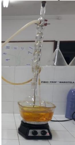
Figura 13- Separação das fases do óleo, catalisador e álcool.
