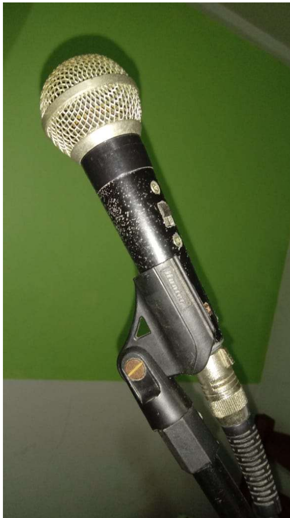
Figura 5: Microfone direcional com plug Canon
