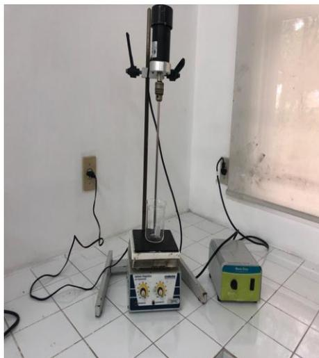
Figura 10 – Sistema para troca iônica bentonita sódica e bentonita cálcica (representação para um ponto)
