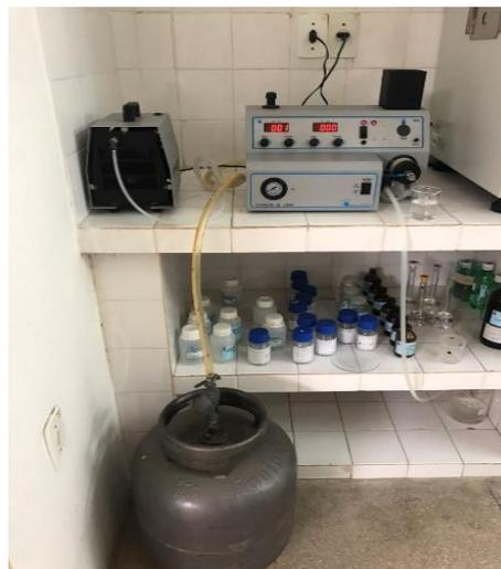
Figura 11 – Fotômetro de chama para a determinação quantitativa de íons
