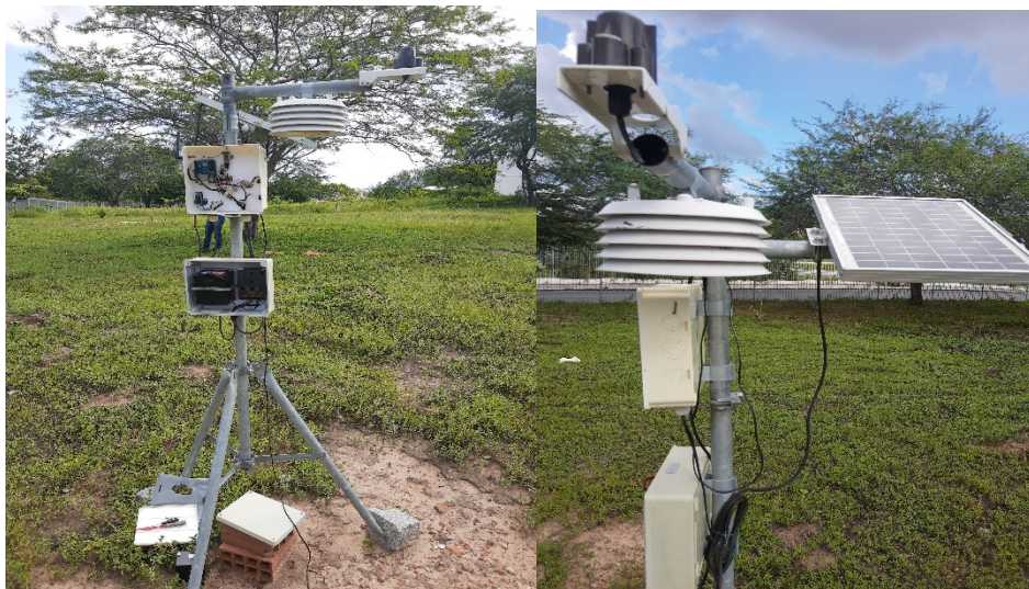
Figura 3 - Sistema composto de Arduino, sistema de bateria e painel solar instalada na área experimental, Campus I UEPB, Campina Grande-PB
