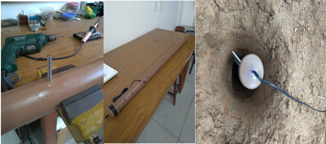
Figura 1. Montagem dos sensores no laboratório e instalação no solo
