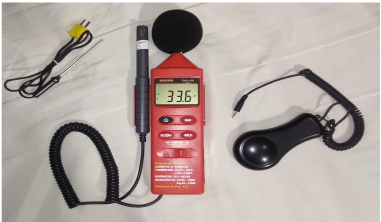
Figura 2 – Aparelho de medição sonora utilizado no monitoramento
