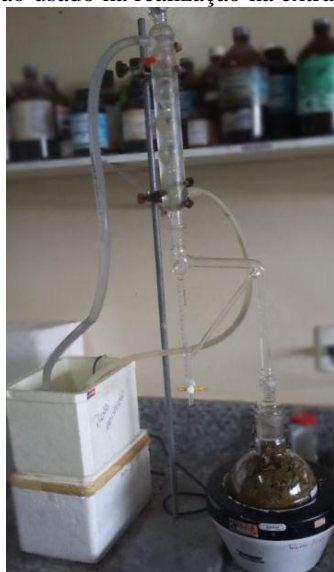
Figura 11: Sistema de hidrodestilação usado na realização na extração do óleo essencial do capim-santo
