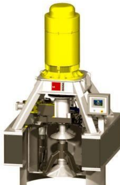
Figura 17: Sistema de automação de uma centrífuga
