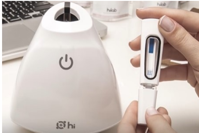
Figura 5 - Exemplo de dispositivo compacto que digitaliza amostras de exames à distância
