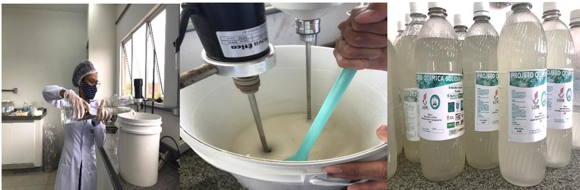
Figura 4 - Processo de adição, mistura e embalagem do produto álcool em gel.
