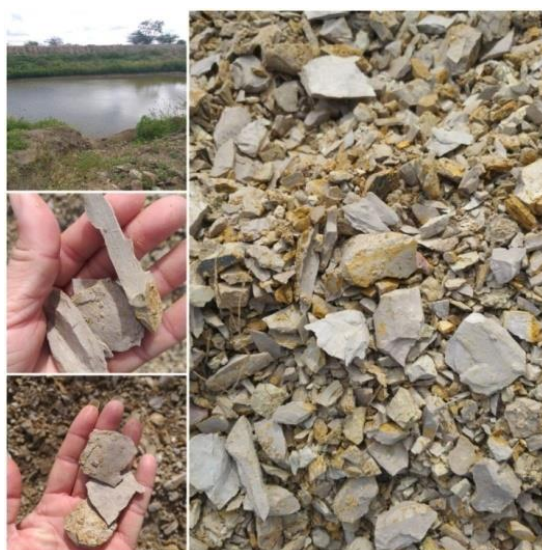
Figura 15- Bentonita amarela ED e jazida de onde ela foi extraída.
