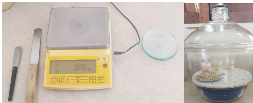
Figura 18- Aparelhagem utilizada para realização da análise do teor de umidade.
