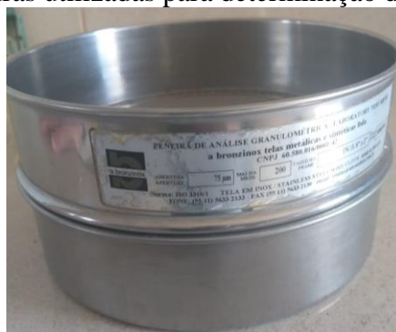
Figura 19- Peneiras utilizadas para determinação de granulométrica.
