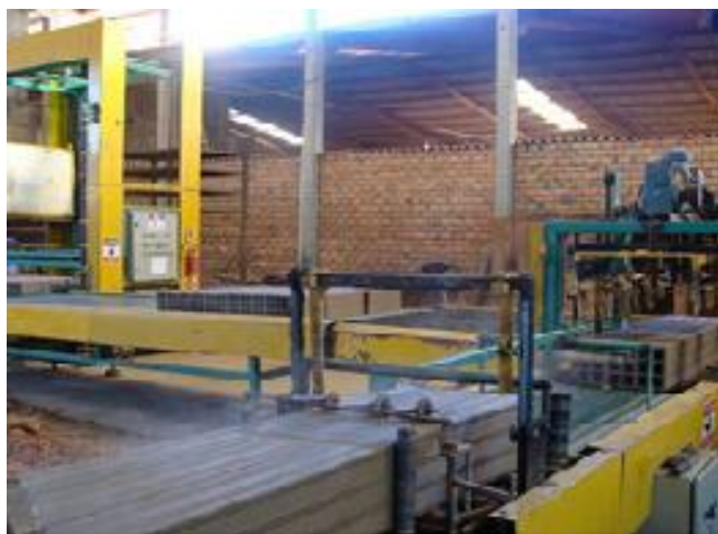
Figura 2 Processo de prensagem e extrusão de tijolo
