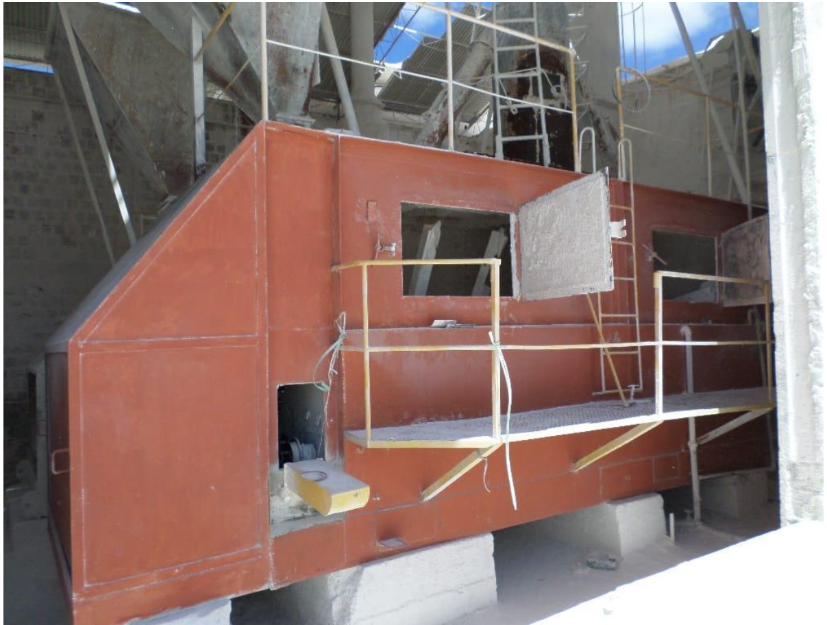
Figura 8 - Tanque de hidratação
