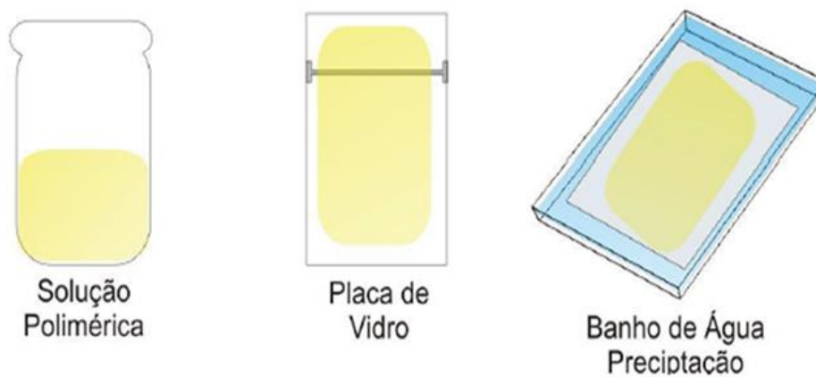
FIGURA 1 - Representação esquemática das etapas envolvidas na formação de membranas por imersão em banho de não solvente
