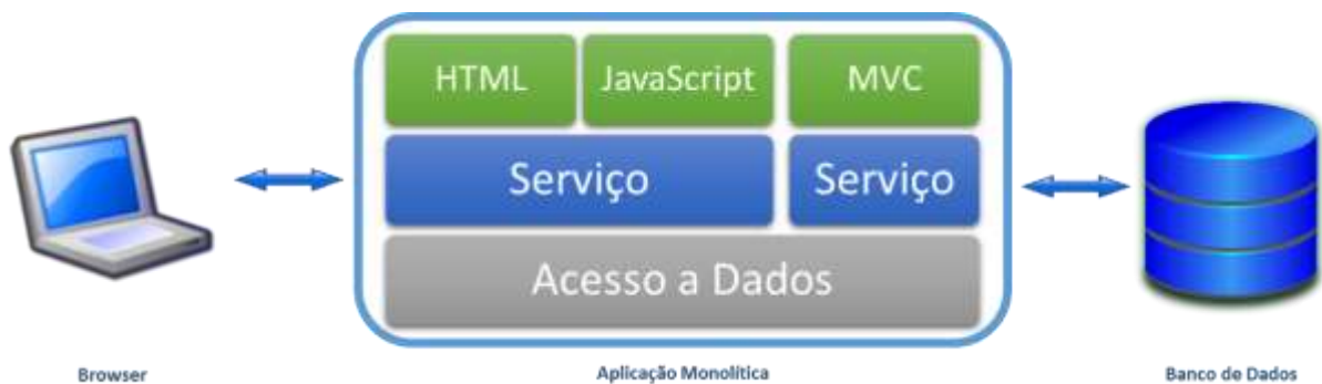
Figura 1: Exemplo de arquitetura web monolítica. Fonte: (OPUS Software, 2021)
