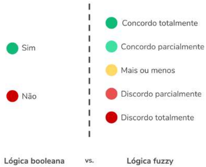
Figura 9: Exemplo de lógica booleana e lógica fuzzy. Fonte: (YAMASSAKI, 2020)
