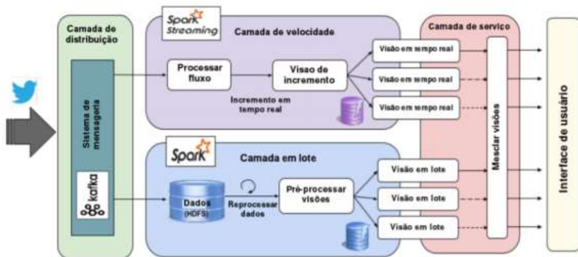
Figura 3: Arquitetura usada no EPIC Real-Time. Fonte: (REIS, 2018, p. 34)
