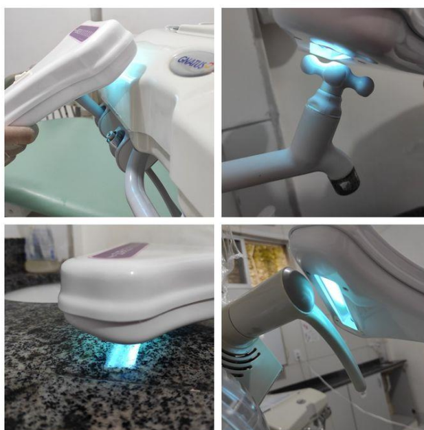
Figura 6 — Aplicação da luz UV-C nas superfícies dos consultórios odontológicos (cárter, torneira, bancada e alça do refletor)
