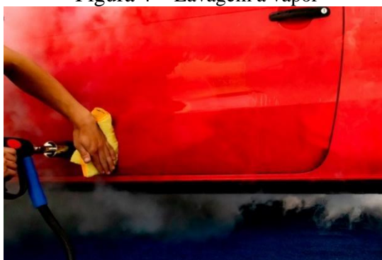
Figura 4 – Lavagem a vapor
