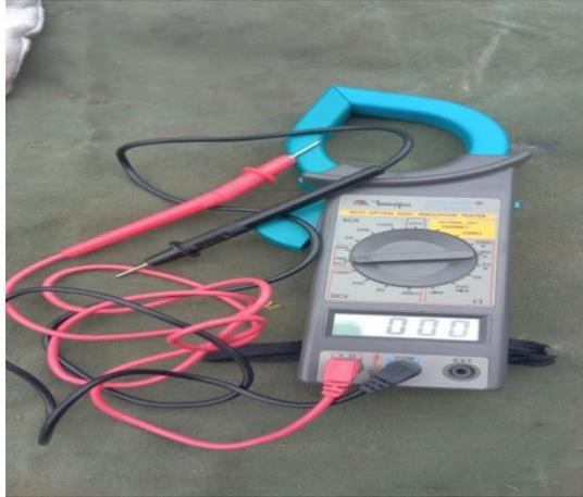
Figura 11. Amperímetro digital ou alicate amperímetro.
