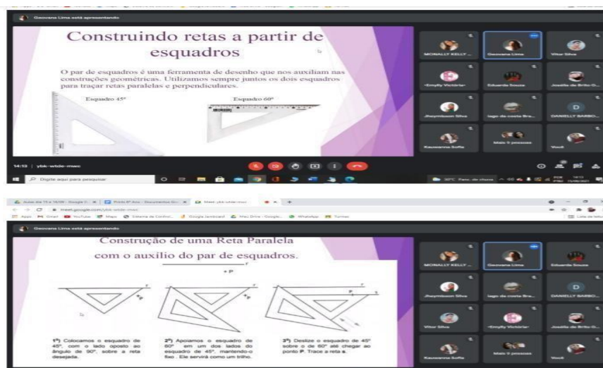
Figura 5: Construção de retas com auxílio de esquadros
