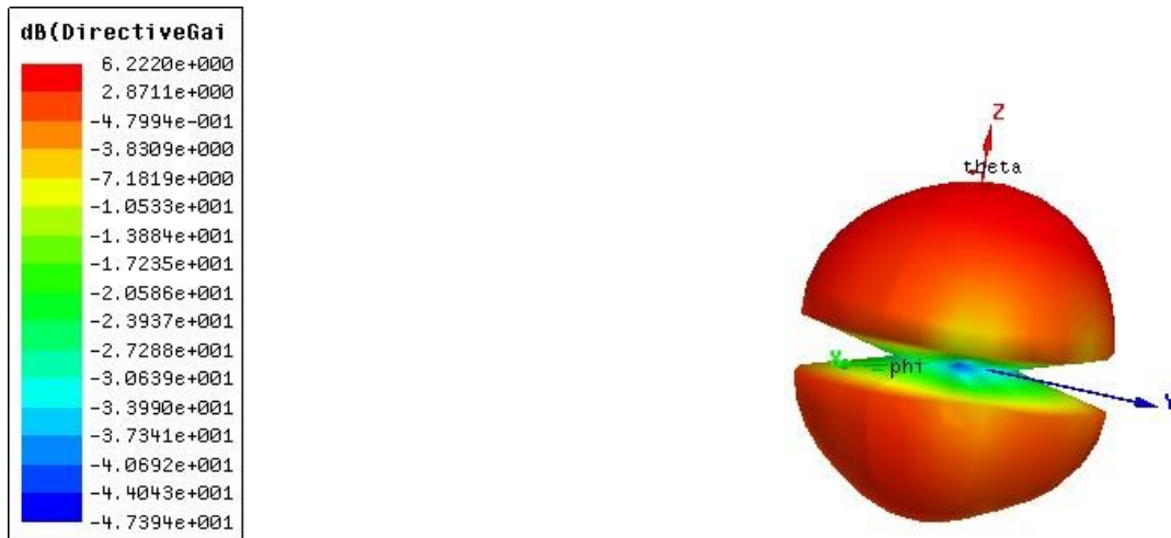
Figura 16: Diagrama de radiação destacando o ganho diretivo de uma antena.
