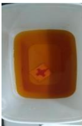
Figura 27. Processo de corrosão da antena A1 na solução de percloroeto de ferro.
