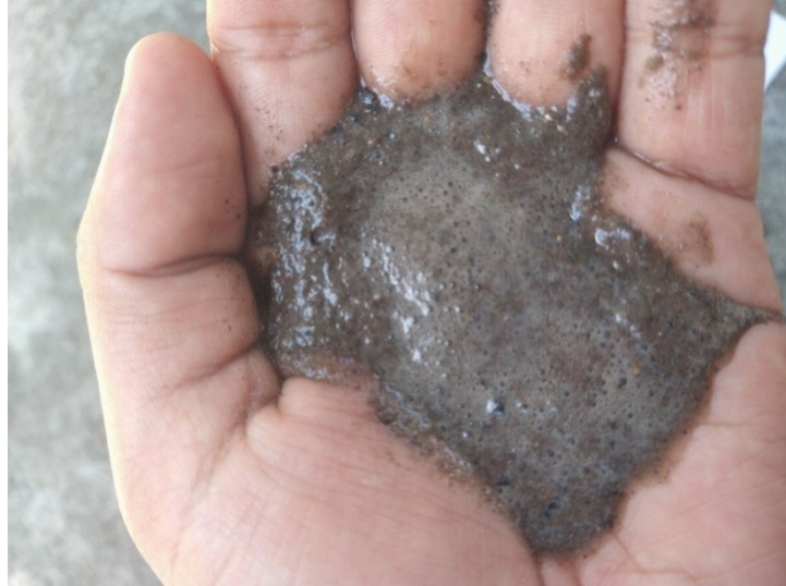
Figura 3 – Reação de peroxidação (Solo + Peróxido de nitrogênio)
