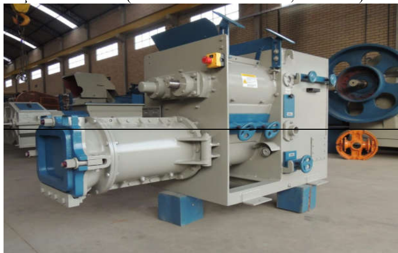
Figura 5- Ilustração de extrusora (maromba a vácuo MN-2B, NATREB)
