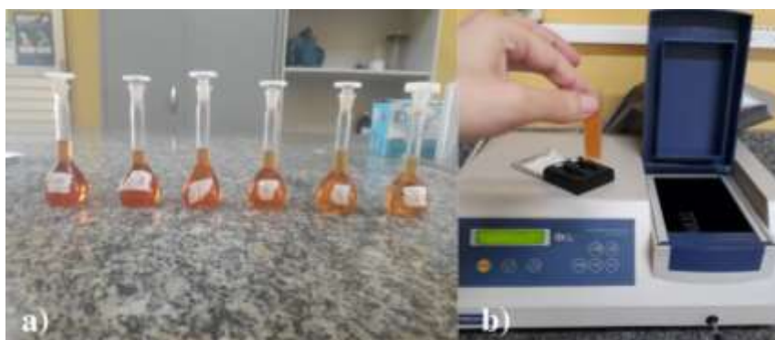
Figura 4 – Processo de montagem da curva de calibração. a) Solução em repouso. b) Leitura no espectrofotômetro.
