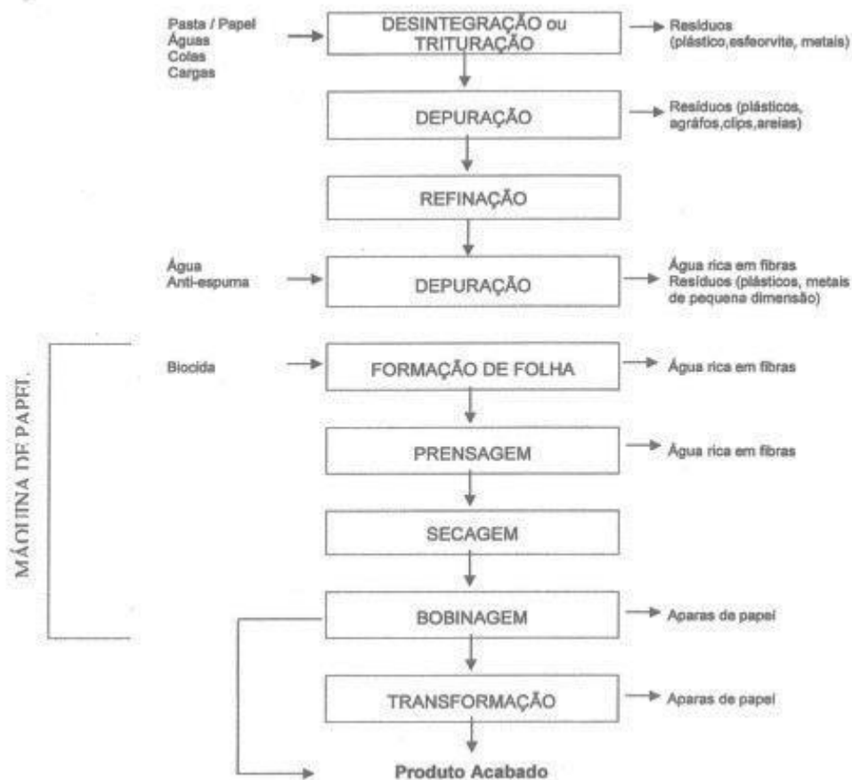
Figura 2 — Fluxograma genérico do processo de fabrico do papel
